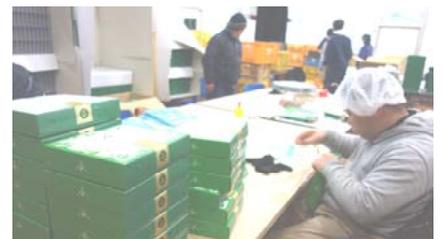
▲箱の製造と組立作業、箱折作業
